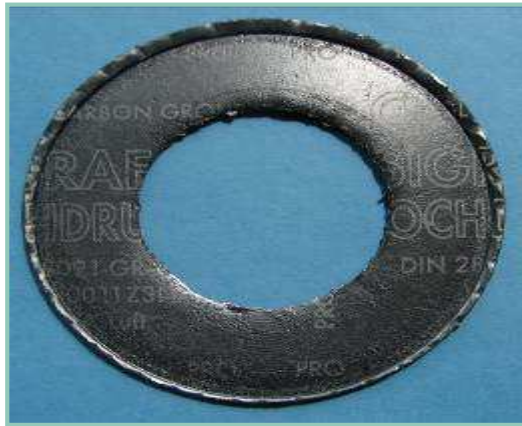
SIGRAFLEX® HOCHDRUCK PRO after 200 N/mm 2 at 300 °C
