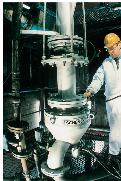
STENFLEX ® Typ R-1 w urządzeniu dozującym
