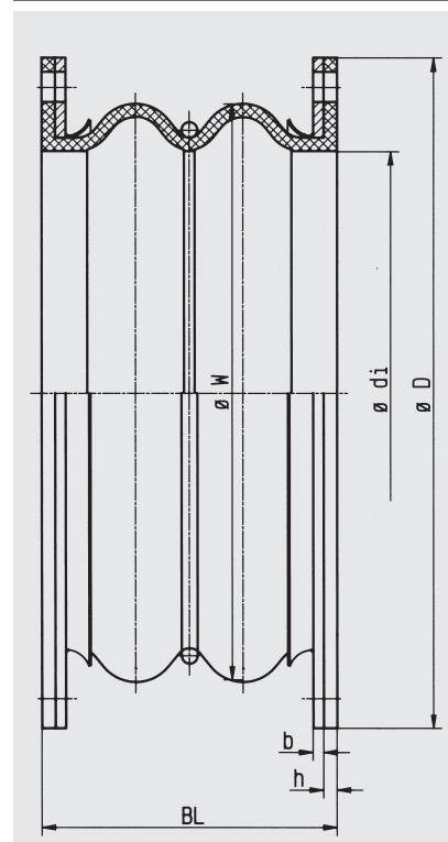
Typ C-2 wysoko elastyczny, uniwersalny kompensator, bez ograniczników
